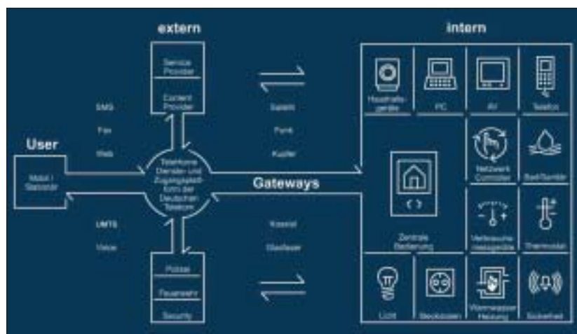
Bild 3. Architektur der inHausanbindung an die TeleHome-Plattform
