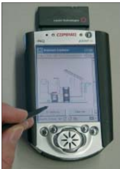
Bild 2. Bedienoberfläche der Viessmann-Heizung
